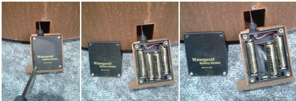
Foto 7: Batterientausch im Batteriebehälter
